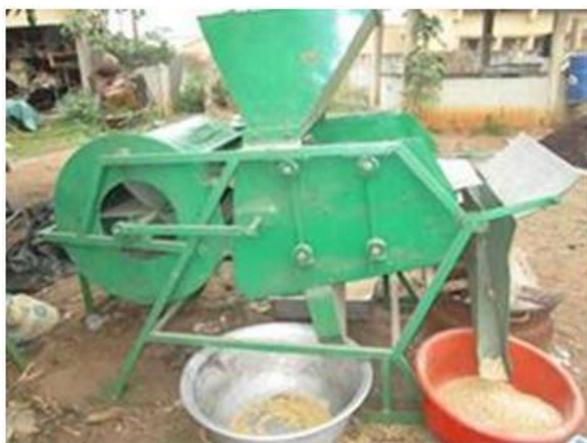
Figure 13: Nettoyeuse-vanneuse motorisée
