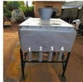
**Figure 3: Trieuse-calibreuse de riz avec quatre ouvertures**
