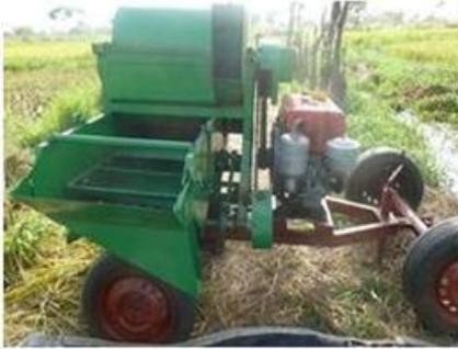
**Figure 1 : Batteuse-vanneuse à paille non tenue de 15 CV (BVPNT 15 CV)**
