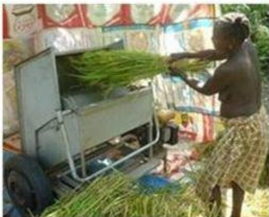
**Figure 7 : Batteuse simple à paille tenue (BSPT 6 CV)**
