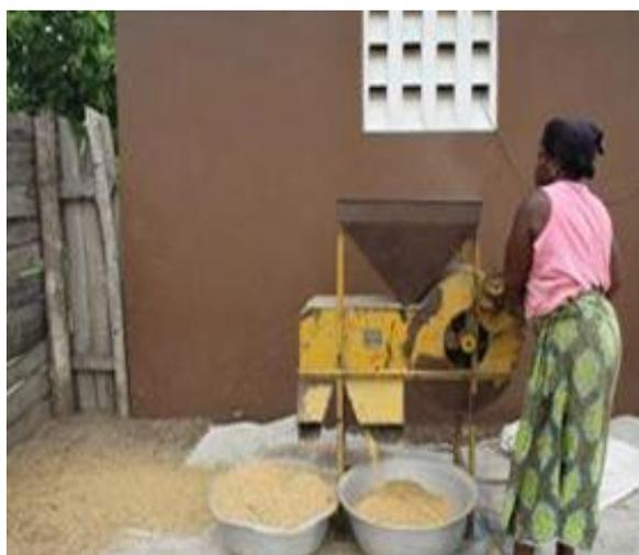
Figure 12 : Vannage mécanique
